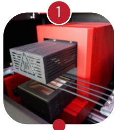
Motor elétrico do forno com movimento x e y
