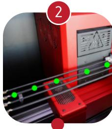
5 posições de retração diferentes com possibilidade de ter diferentes parâmetros de processo
