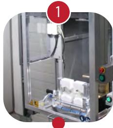
Proteção em acrílico que permite um uso limpo, protegido e livre de calor para o operador
