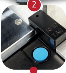
Sistema RFID com deteção do gabarito de retração para carregamento automático de parâmetros de processo
