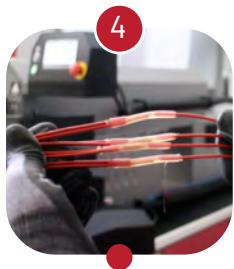
Comprimento dos tubos termoretráteis entre 30 e 90mm
